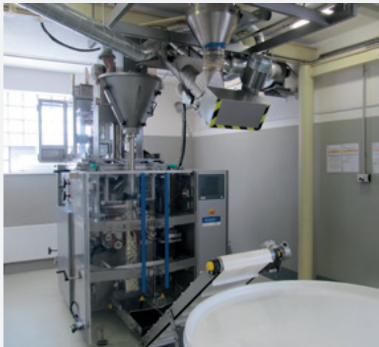
Plně automatizovaný multifunkční míšící a balící stroj od společnosti Velteko, s. r. o.
