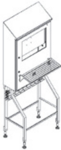
Obr. 8: Nosné rámy musejí být odolné vůči náklonu
