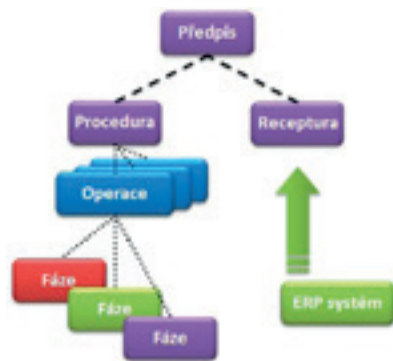
Obr. 6: Struktura pružného recepturového řízení dávkových výrob (dle normy ISA 588)
