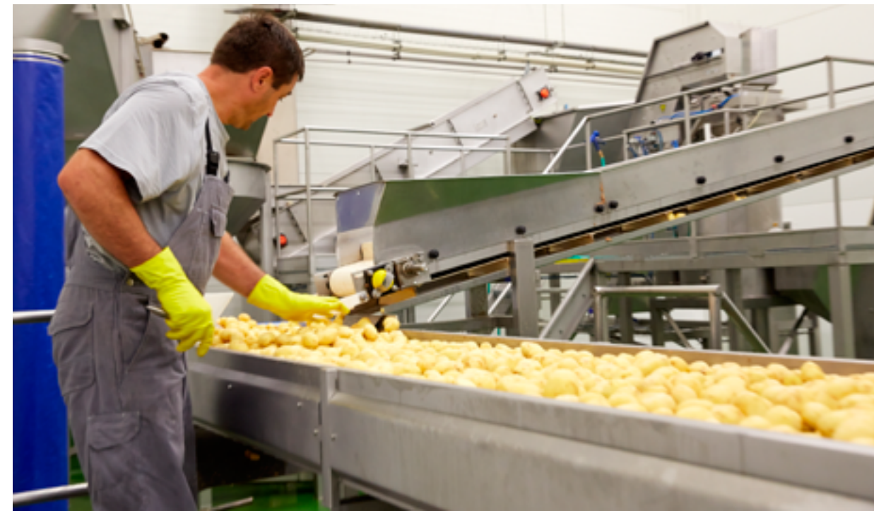
Aby se podavač zatím neoloupaných brambor neucpal také ještě hlídá člověk
