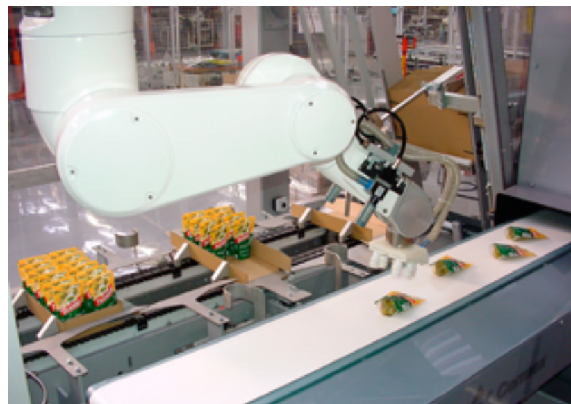
Robot instalovaný na strop šetří mnoho místa při skládání hotových výrobků do balení.
