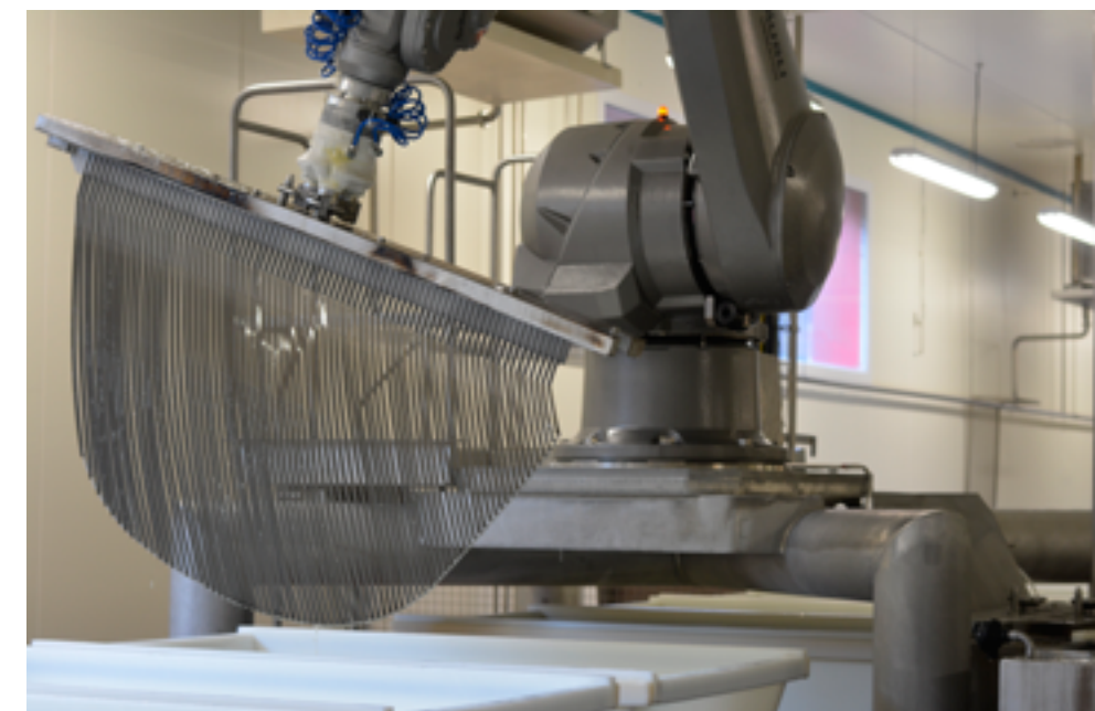
Obr. 2: Robot Stäubli model TX200 he (humid environment) do vlhkého prostředí v potravinářském průmyslu
