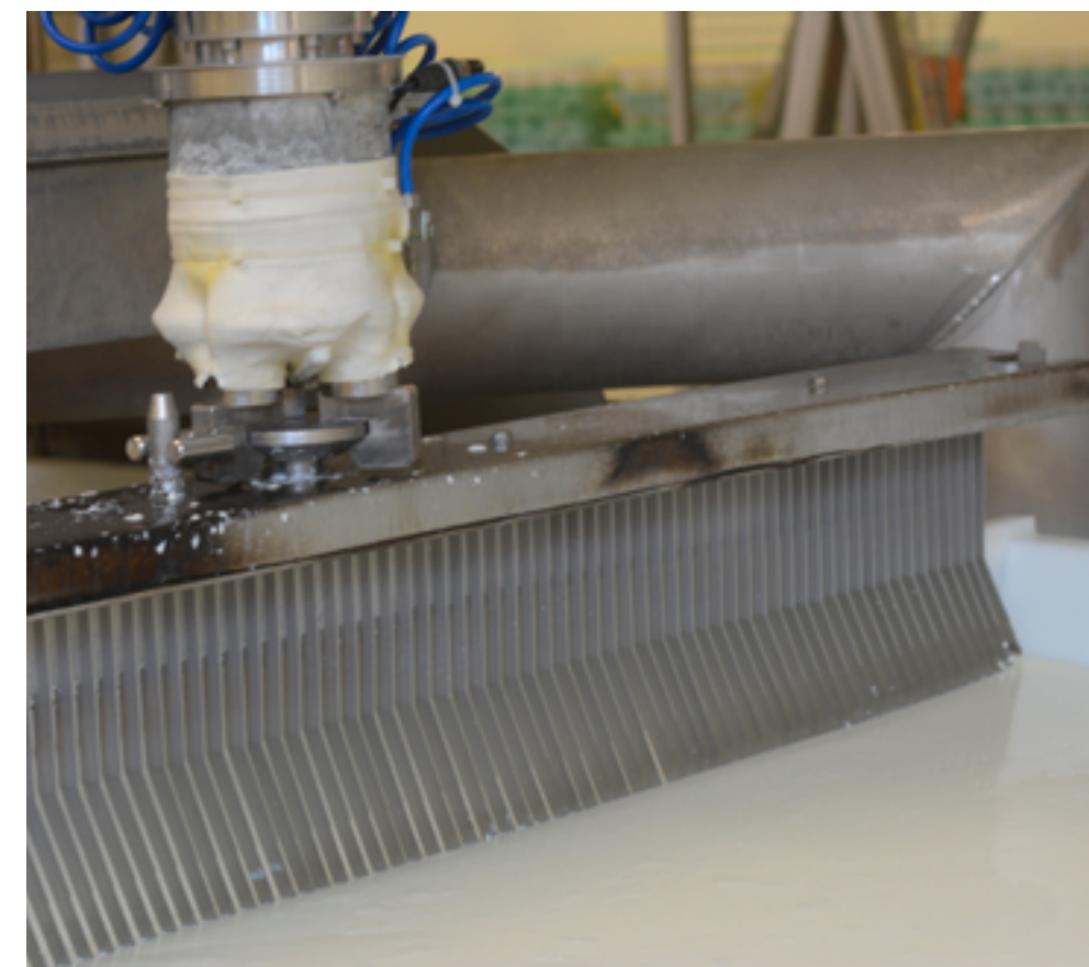
Obr. 3: Robot promíchává sýřeninu pomocí nástroje – sítě
