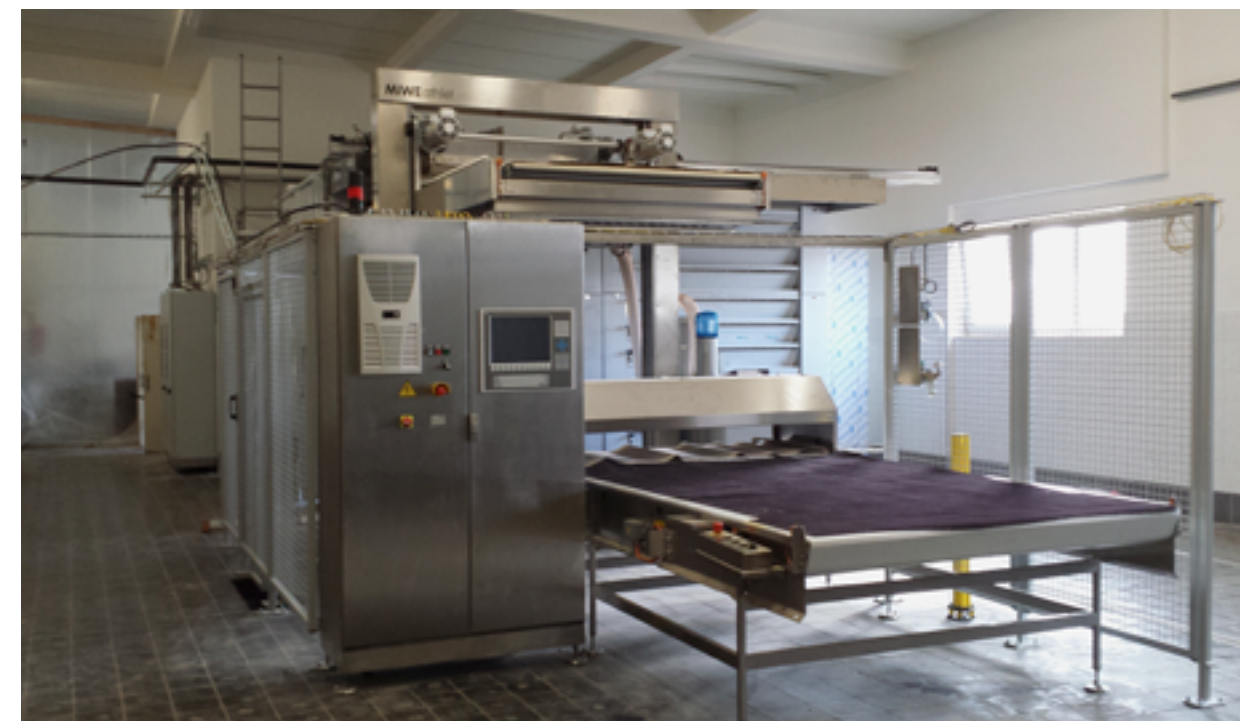
Obr. 2: Instalace osazovacího asistenta MIWE Athlet pro etážovou pec
