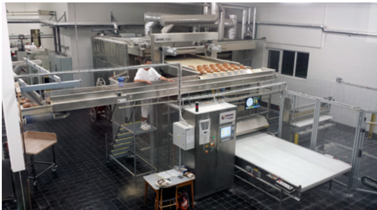
Obr. 3: Etážová pec MIWE thermo-express s osazovacím asistentem MIWE Athlet
