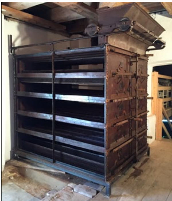
▲ Pohled na nově rekonstruovaný funkční jednoduchý šestipatrový hvozď systémů Ječmen, který byl zachráněn z bourané sladovny v Zahrádkách u Sedlčan a nově osazen v pivovarském muzeu v Kostelci nad Černými lesy. Druhý podobný je ještě dochován v klášterním pivovaru ve Vyšším Brodě.
