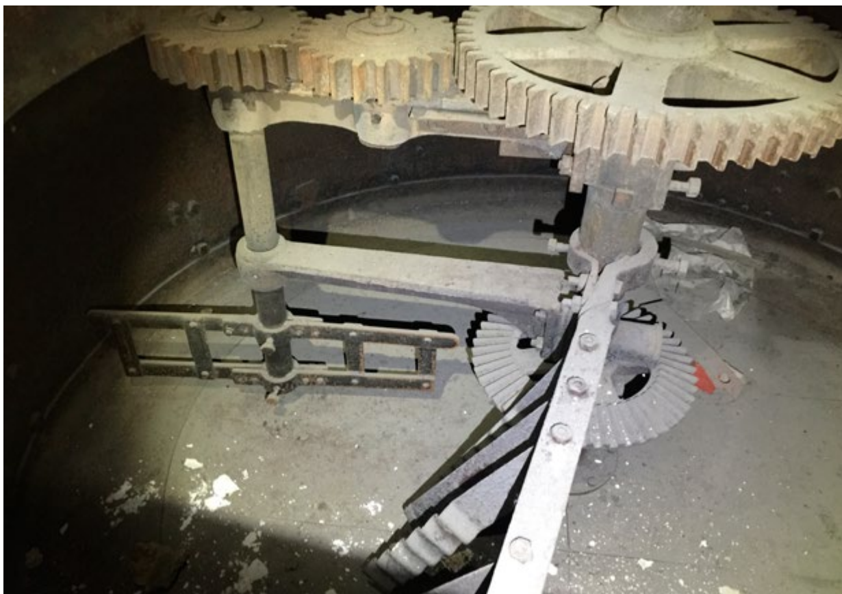
▲ Relikt složitého míchadla a v podstatě kompletní historická varna ze 70. let 19. století se dodnes dochovala v bývalém pivovaru v Levoči.
