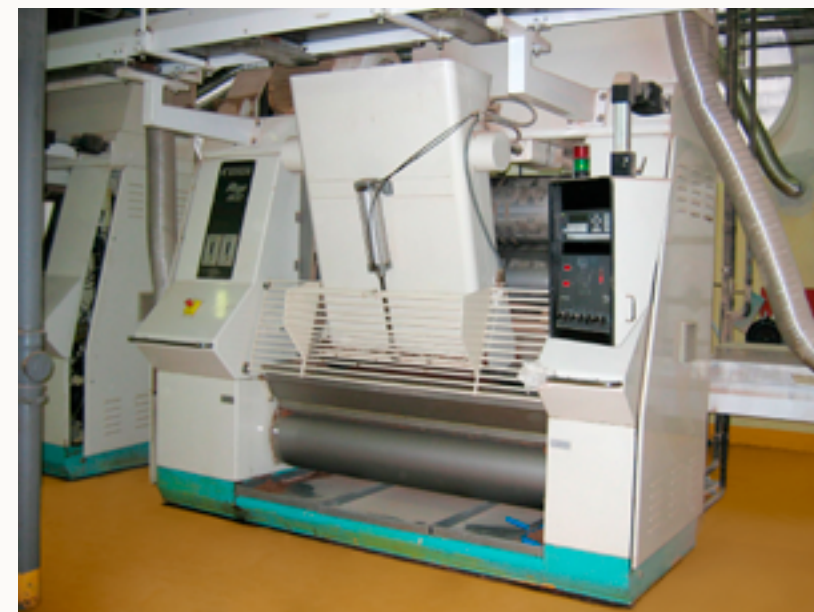
Obr. 2: Pětiválec válcovny čokoládových hmot.
