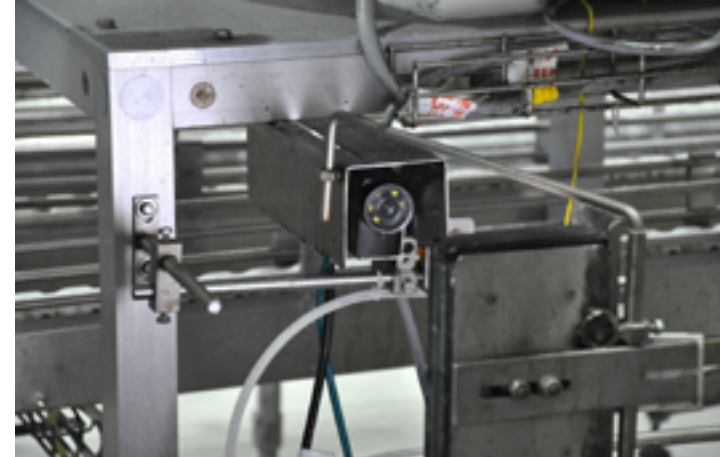
Obr. 2: Cognex Checker přebírá kontrolu nad pozicí uzávěru tetrapaku.
