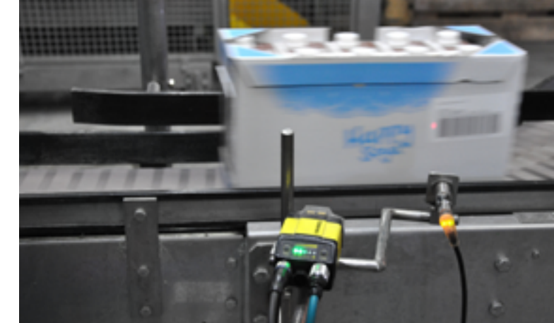
Obr. 3: Cognex DataMan 300 prověří 1D kód na obalu a sníží tak možnou následnou vratku zboží od zákazníků.
