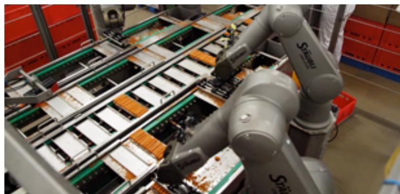
Obr. 4: Rozhodující faktor: roboty Stäubli jsou schopny spolupracovat s dopravníkem pohybujícím se rychlostí 30 metrů za minutu pro rovnání rybích prstů do balení.
