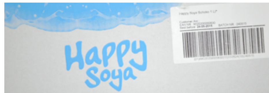
Obr. 4: Pokud je kód nepoškozený, zůstává karton v procesu. V případě, že je poškozený, je výrobek vyrazen k novému etiketování.
